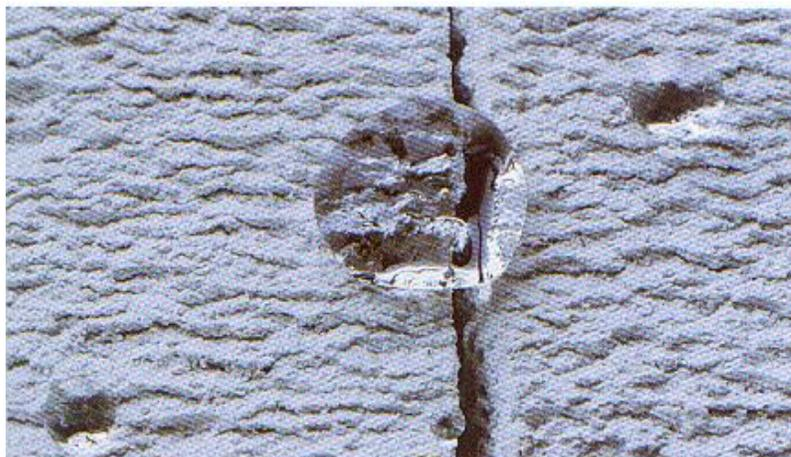
Ação de repelência à água dos hidrofugantes à base de silano/silixano
